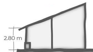
Cubierta inclinada con sombreado en acceso
