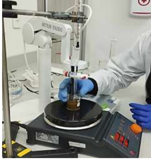
Figura 4. Ajuste de pH con HCl 0.1 M y NaOH 0.1 M. Realizado por: Guevara Ruth, 2024
