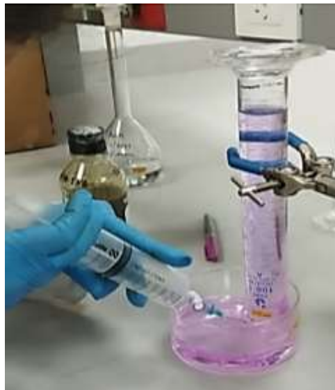
Figura 3. Sistema de medición por desplazamiento volumétrico Fotografía tomada por: Guevara Ruth, 2024
