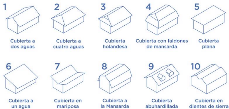
Figura 33. Tipologías de cubiertas
