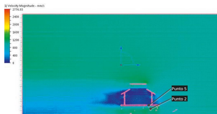
Figura 65. Simulación de magnitud de velocidad del modelo de prueba 3 – 3 de la vivienda Minahasa. Fuente: (Kristianto et al., 2014)
