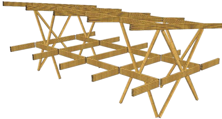
Figura 62-3. Estructura portante de bambú de la edificación demostrativa.
