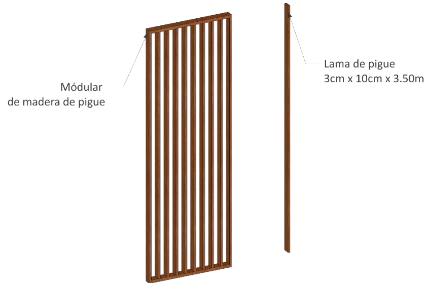
Figura 57-2. Módulo de madera de Pigüe la edificación demostrativa. Fuente: Elaboración propia. Jairo Villalva, 2024.
