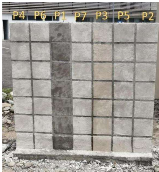
Imagen 10. Muro experimental después de la aplicación de las pastas, Cara B. Realizado por: Jesús March, 2022.
