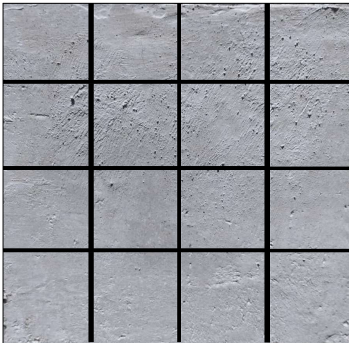
Imagen 11. División de cada probeta para el cálculo de porcentaje de fisuras.
