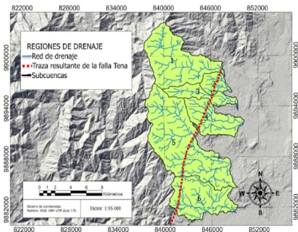
Figura 7. Principales subcuencas hidrográficas de la zona de estudio. Se identifican seis principales subcuencas hidrográficas, señaladas con números (1 – 6). La traza de la falla Tena es señalada con una línea disconti-
