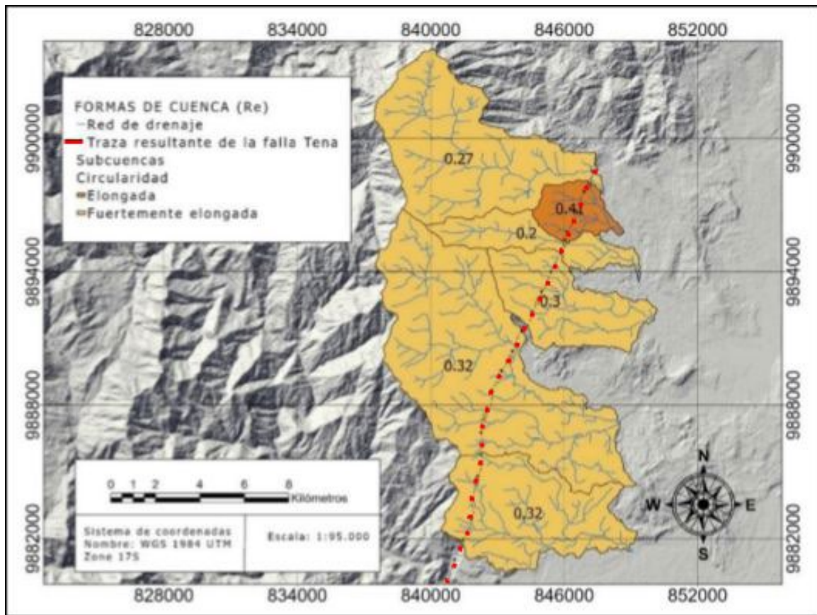
Figura 10. Mapa del índice de forma de la cuenca (Re). Las cuencas son clasificadas en elongada y fuertemente elongada. El valor del índice obtenido para cada subcuenca está señalado con un número sobre el área de la
