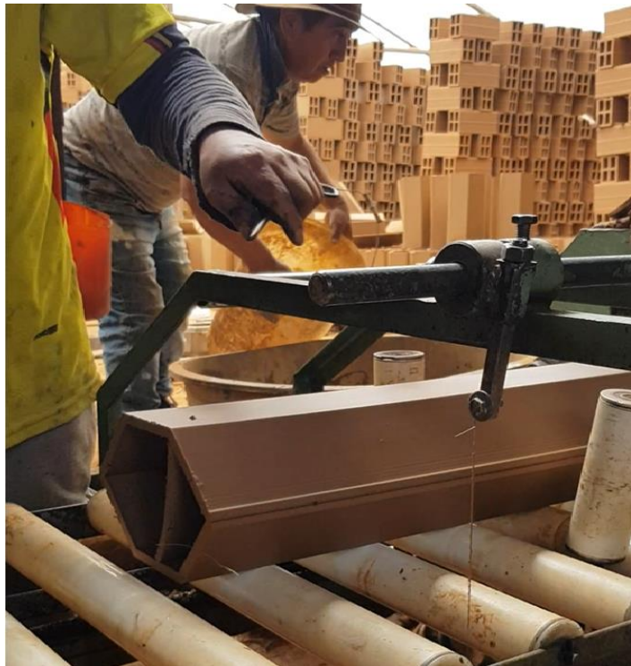
Figura 13-2: Proceso de elaboración de tejas vidriadas Elaborado por: Castro Juan, 2024
