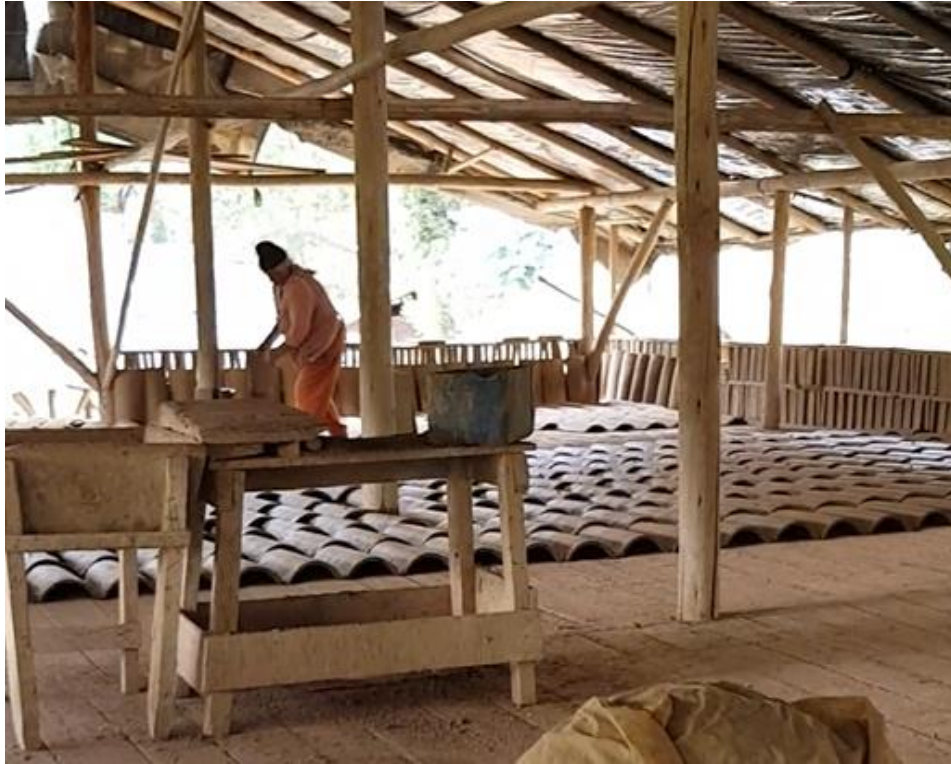
Figura 15-2: Proceso de secado natural de teja, previo al ingreso al horno. Elaborado por: Castro Juan, 2024
