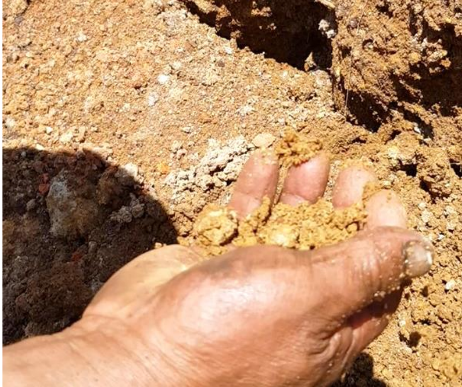
Figura 8-2: La arcilla recién extraída debe pasar por un proceso de trituración para romper rocas pequeñas que pueda contener.
