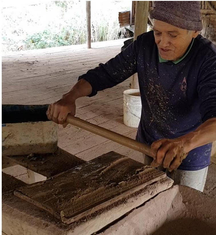
Figura 14-2: Elaboración completamente artesanal de tejas Elaborado por: Castro Juan, 2024
