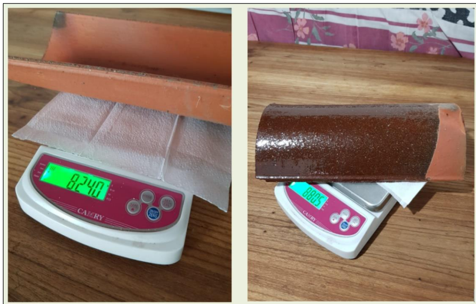
Figura 1-3: Peso de teja artesanal Vs. teja artesanal vidriada Elaborado por: Castro Juan, 2024
