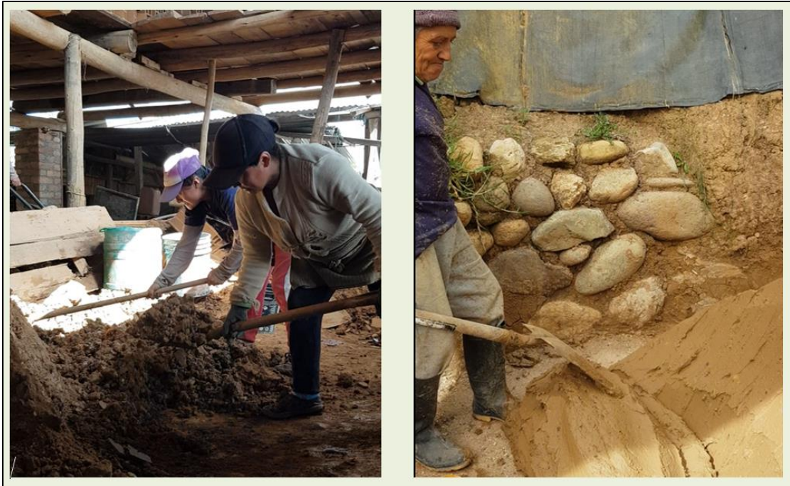
Figura 4-3: El transporte interno y la mezcla del material se produce de forma artesanal en el caso de la fábrica semi industrial y fábrica artesanal.
