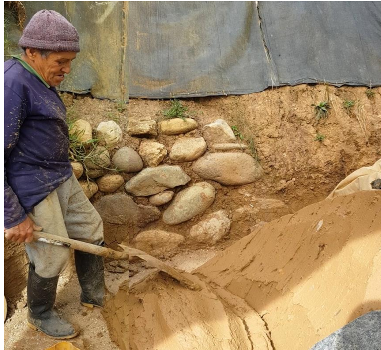
Figura 12-2: Colocación de la mezcla de arcillas, dentro de un espacio conocido como “Noque” (Teja artesanal) Elaborado por: Castro Juan, 2024
