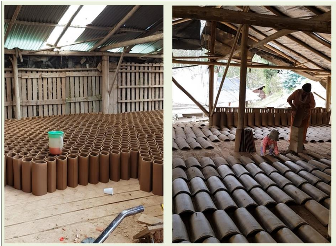
Figura 6-3: El secado de las tejas se produce de forma natural en espacios cubiertos destinados para este fin, tanto en el caso de la fábrica semi industrial, como en el de la fábrica artesanal Elaborado por: Castro Juan, 2024
