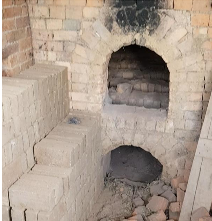
Figura 16-2: Horno en el que se produce la quema de tejas Elaborado por: Castro Juan, 2024
