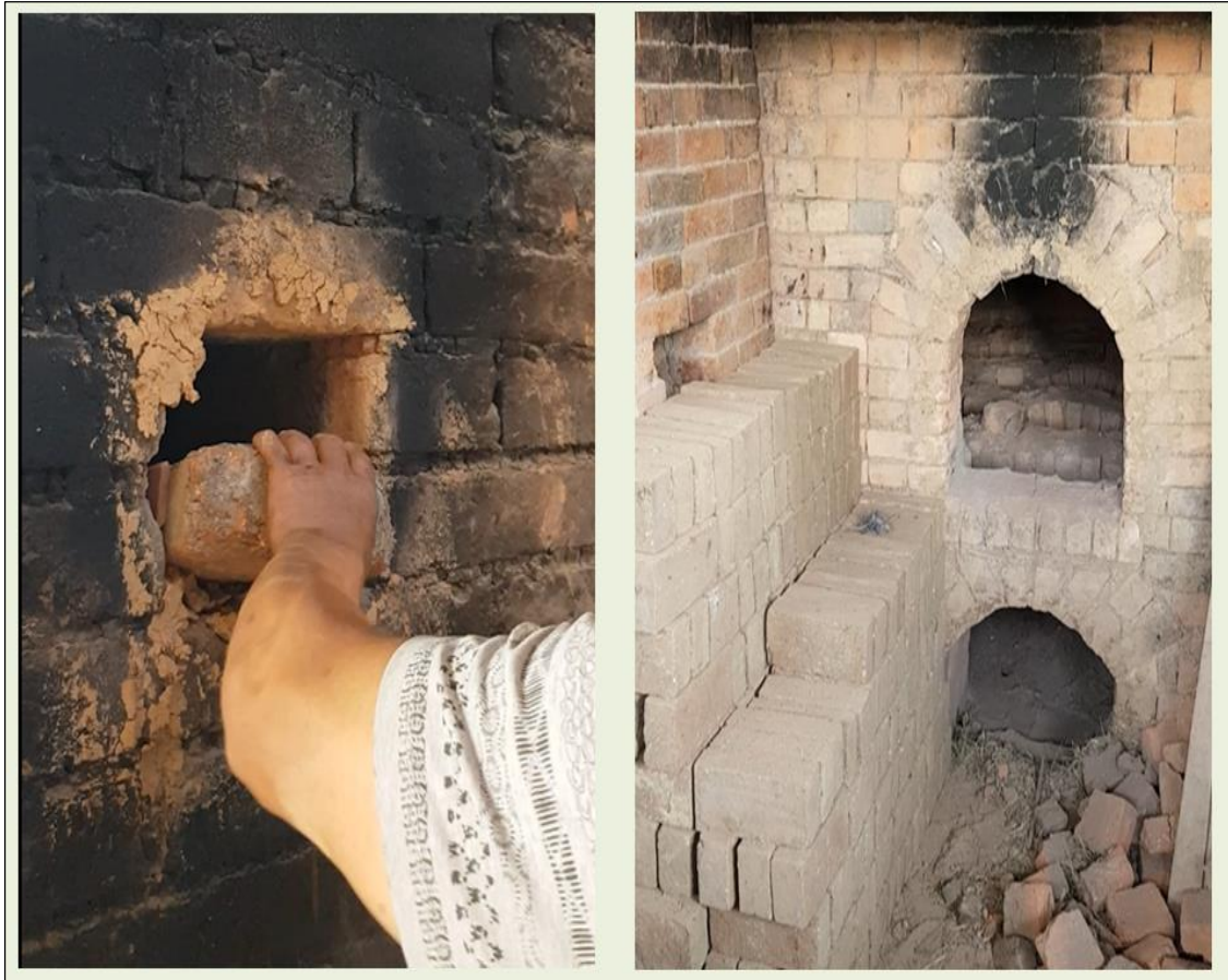
Figura 7-3: Hornos utilizados para la quema de las tejas. En el caso de la fábrica semi industrial (izquierda) se hace uso de un ventilador eléctrico para acelerar el proceso de combustión.
