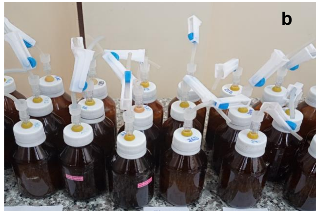
Anexo 1-A: Experimentación (a), Sistema de medición para los ensayos AME y PBM (b), Reactores Batch para los ensayos AME y PBM.
