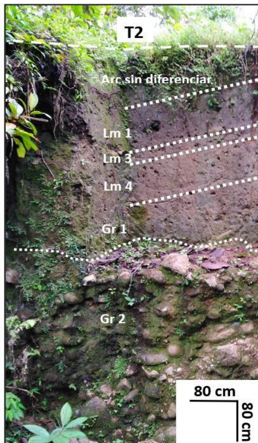
Figura 4. – Depósito presente en la Exc – 3. En la imagen se aprecian 6 facies sedimentarias. En la parte basal se identifican las facies Gr 2 y Gr 1. En la parte media y superior de la sección estratigráfica varían de depósitos de limo arcilloso arenoso (facies Lm 4) a arcilla limosa (facies Arc 1).
