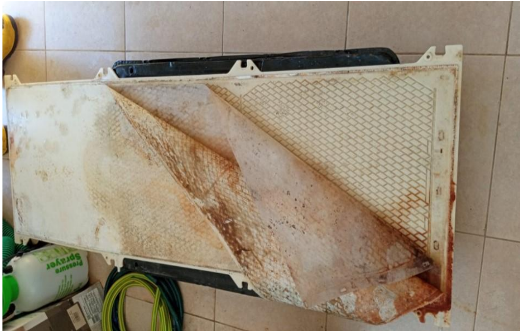
Anexo 8. Membrana PES de PTAR-MBR en la ciudad de Tena. Luego de un cambio por mantenimiento, se observa las incrustaciones y ensuciamiento de membrana.
