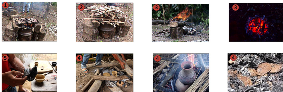
FIGURA 4. QUEMA DE OBJETOS CERÁMICOS DE TAMAÑO PEQUEÑO. 1) AHUMADO. 2) PREPARACIÓN DE HORNO. 3) QUEMA. 4) REPOSO. 5) COLOCACIÓN DE CIRKILLU . FUENTE: SOLÓRZANO ET AL. 2018, MODIFICADO POR LAS AUTORAS.
