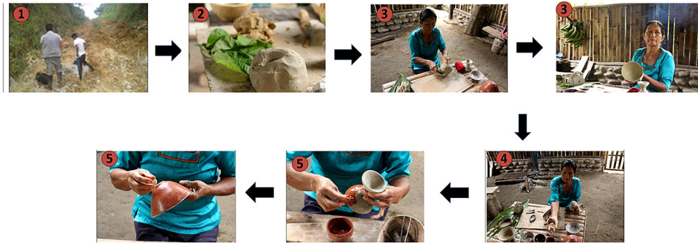
FIGURA 3. SISTEMA DE PRODUCCIÓN CERÁMICO: 1) RECOLECCIÓN DE BARRO –ALLPA MANKA-, 2) PREPARACIÓN DEL BARRO. 3) COLOCACIÓN DE CORDELES E IGUALADO. 4) PULIMENTO. 5) COLOCACIÓN DE ENGOBE. COMUNIDAD TÍYUYAKU. FUENTE SOLÓRZANO ET AL. 2018, MODIFICADO POR LAS AUTORAS.
