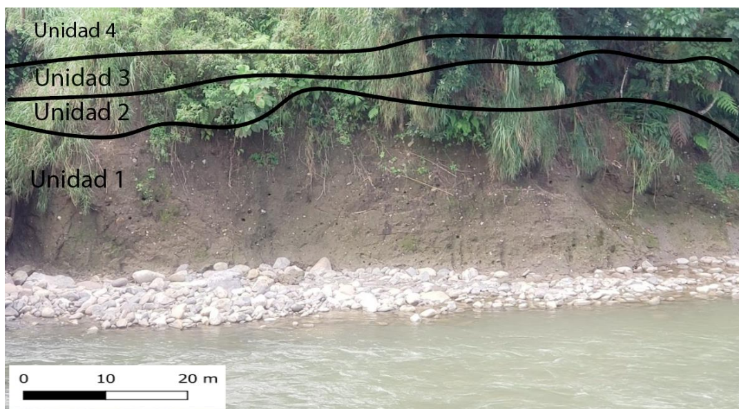
Figura 14: Disposición espacial de las capas geológicas a partir de la imagen real de la zona de estudio.
