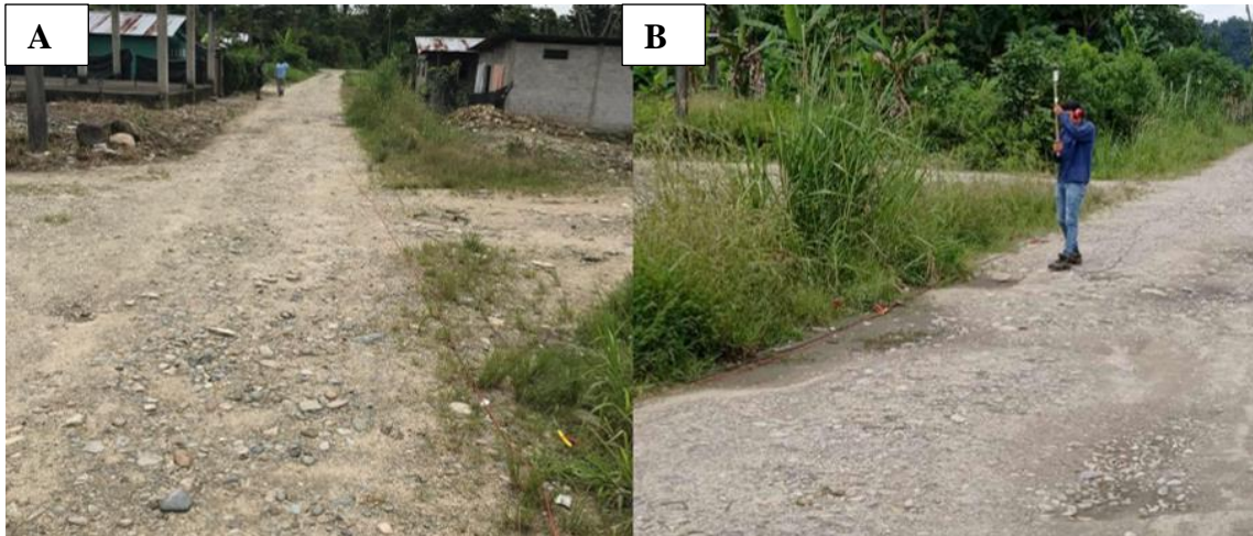
Figura 3. Adquisición de datos geofísicos en campo sobre un relleno estructural en la calle de la comunidad San Pedro de Muyuna. A) Disposición de la línea geofísica de 120,0 m de longitud en dirección N64°E. B) Golpeo mediante un martillo sobre una placa de aluminio para la adquisición de datos sísmicos.
