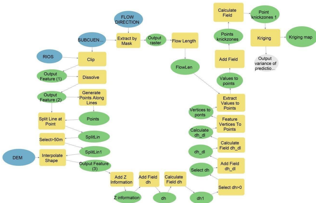
Figura 7. Modelo de trabajo para calcular el índice de Hack (SL) y obtener los puntos anómalos (knicpoints).
