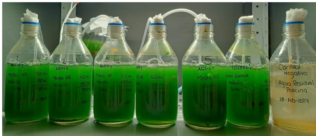
Figura 2-6. Sistema de tratamiento por lotes para la primera fase de adaptación de A. platensis
