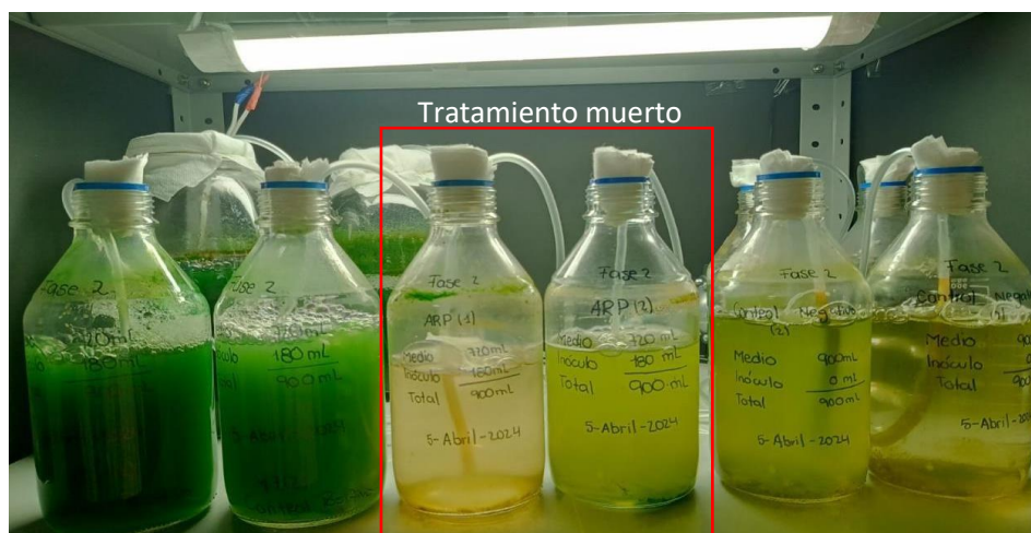
Figura 3-10. Sistema de tratamiento de aguas residuales porcinas muerto de la segunda fase de adaptación al medio (recuadro rojo) con A.
