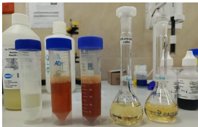
Figura 3-15. Análisis de amonio día 0 (tubos Falcón) vs. día 2 (balón de aforo). Elaborado por: Cunguán & Prado, 2024
