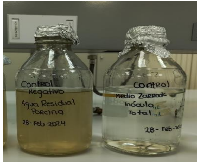
Figura 2-7. Medios de cultivo utilizado en la investigación: agua residual porcina (izquierda) y medio Zarrouk (derecha). Elaborado por: Cungián & Prado, 2024
