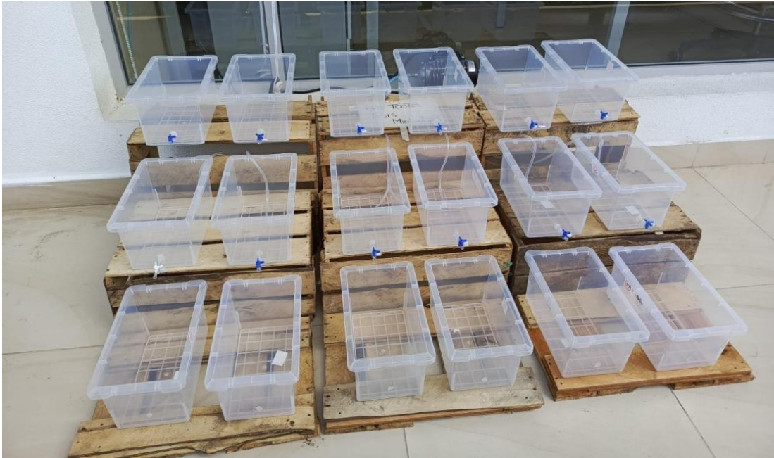
Figura 2-9. Prototipo de un sistema continuo por gravedad para tratamiento de aguas residuales porcinas con A. platensis .
