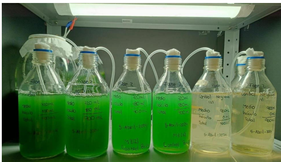
Figura 2-8. Sistema de tratamiento de aguas residuales porcinas en segunda fase de adaptación con A. platensis .
