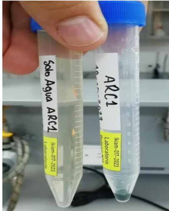
Figura 3-7. Agua Residual Tratada en la primera fase de adaptación con A. platensis (derecha) y biomasa fresca (izquierda).
