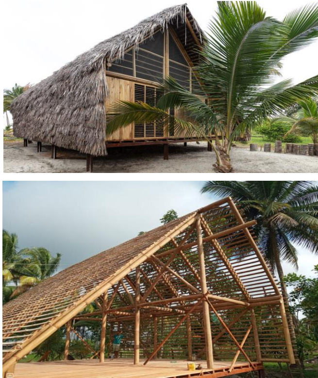
Figura 20. Casa Toquilla, sistema estructural. Fuente: Rama Estudio, 2021.
