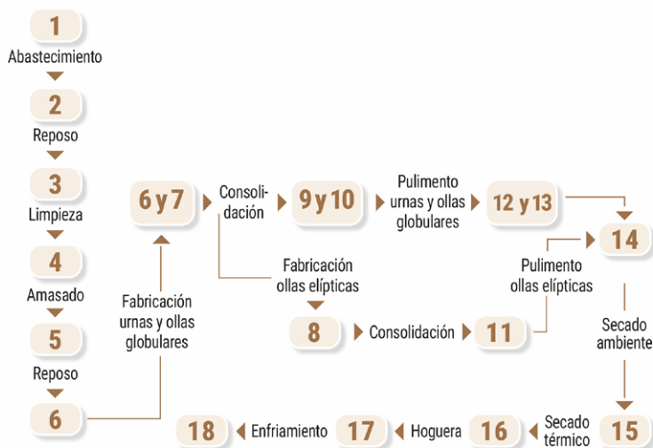
Figura 15. Diagrama CPM de la fabricación objetos cerámicos Tipos Cosanga I recuperados al interior del sitio arqueológico Pashimbi
