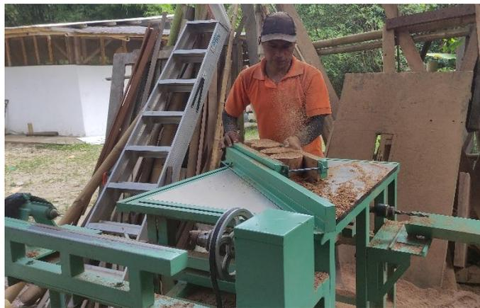
**Figura 2-20.** Máquina para elaboración de elementos conectores AVECE a distintos ángulos de inclinación
