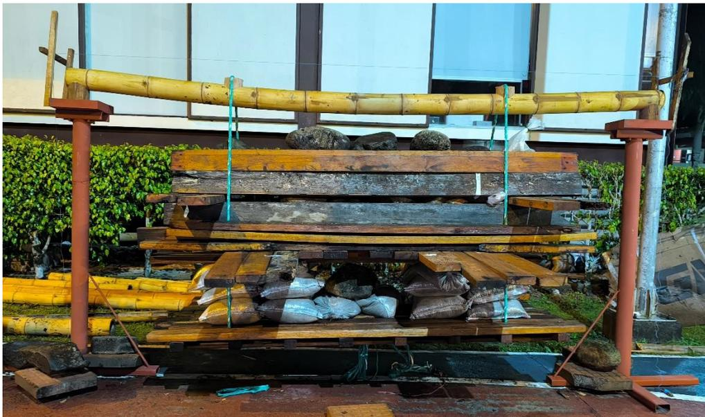
**Figura 2-49.** Experimento de la prueba de cuatro puntos
