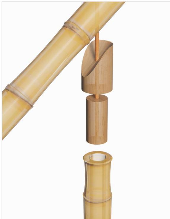
**Figura 2-21.** Conexión AVECE con tarugo de madera
