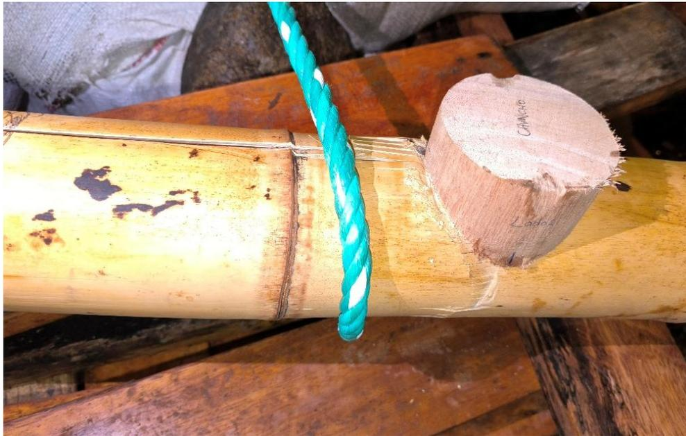
**Figura 3-4.** Falla típica en los puntos de aplicación de las cargas
