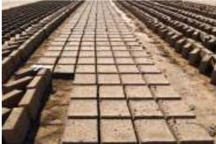
Figura N° 19: Fabricación de bloques de adobe, para construcción de vivienda rural, páramo altoandino Fuente: Proyecto casas abrigadas ADRA
