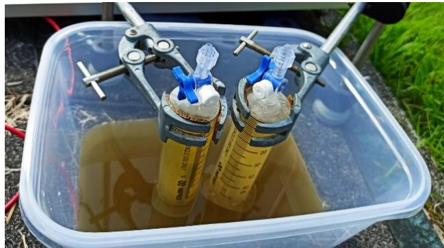
Figura 6. Electroizador a bajo costo: (a) Esquema de la celda electrolítica diseñada; (b) Vista a escala real de la celda
