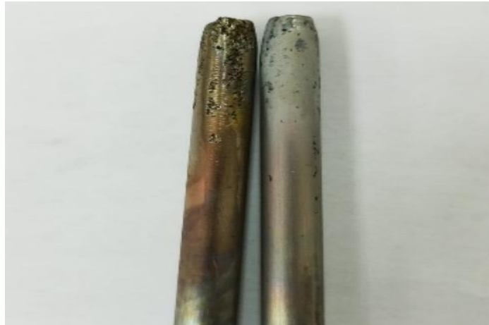
Figura 11. Estado físico de los electrodos ánodo (lado izquierdo) y cátodo (lado derecho) después del proceso de electrólisis
