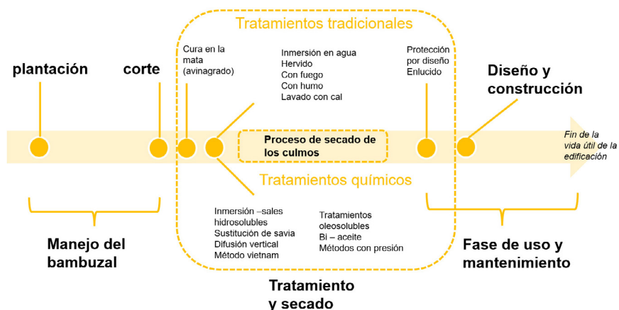
Figura 2. Proceso del bambú como material de construcción (fuente: Elaboración propia, 2018).
