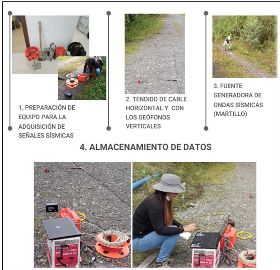
Figura 22. Obtención de señales sísmicas Elaborado por: Karina Salcedo
