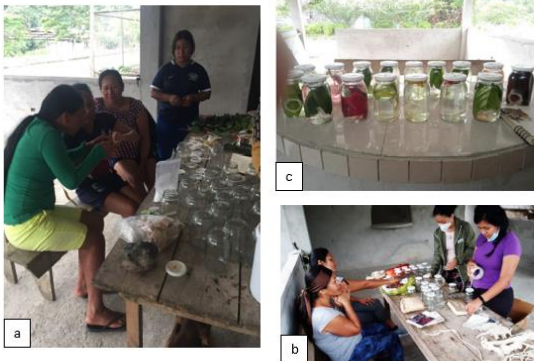
Fotografía 3-6: Fase de pesado-mordentado (a y b) y maceración para el teñido por cocción (c). Realizado por: Encarnación Gabriela, 2023.
