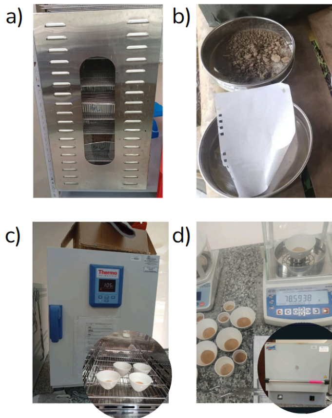
Figura 5. Fase de laboratorio. En a), se observa el proceso de secado del suelo en un deshidratador. En b), el suelo seco es tamizado con un tamiz de malla <2\text{ mm} para obtener las partículas finas de suelo. En c), 10 g de suelo seco y tamizado en crisoles, se colocan en una estufa a 105\text{ }^{\circ}\text{C} . En d), la muestra se coloca en la mufla y se observa posteriormente la toma de los pesos de la muestra.
