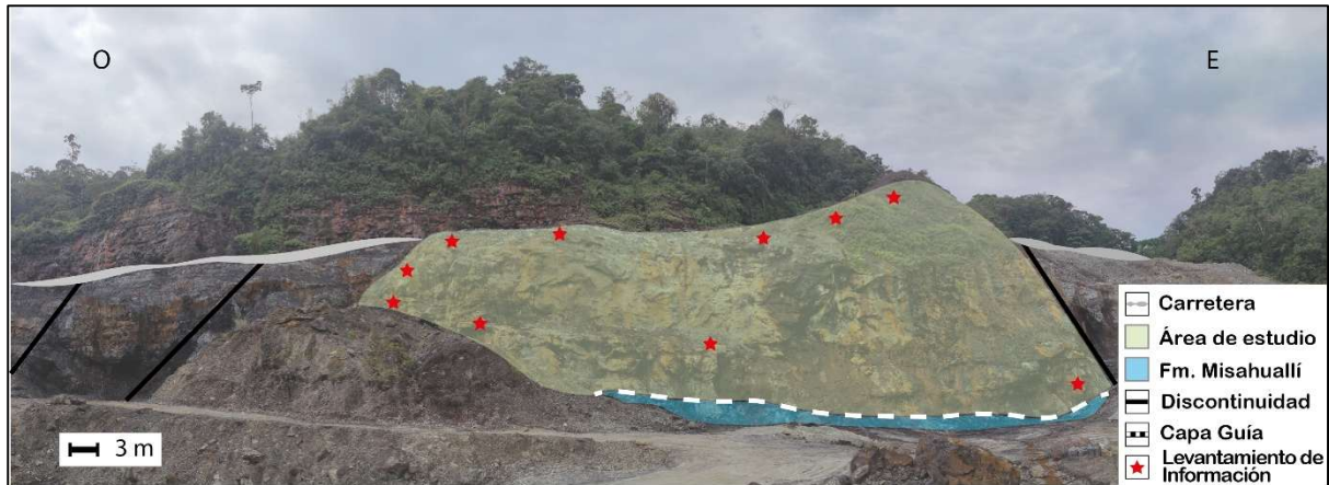
Figura 3. Esquema del levantamiento de información. Esquema representativo de los puntos de levantamiento de información y toma de muestras en el afloramiento de la cantera Pungarayacu. La capa de color celeste, que representa a la Fm. Misahuallí, junto con la línea punteada indican la capa guía que sirvió de referencia en el levantamiento de información. Las líneas sólidas de color negro indican las discontinuidades presentes en la cantera, las cuales permitieron definir el área de estudio.
