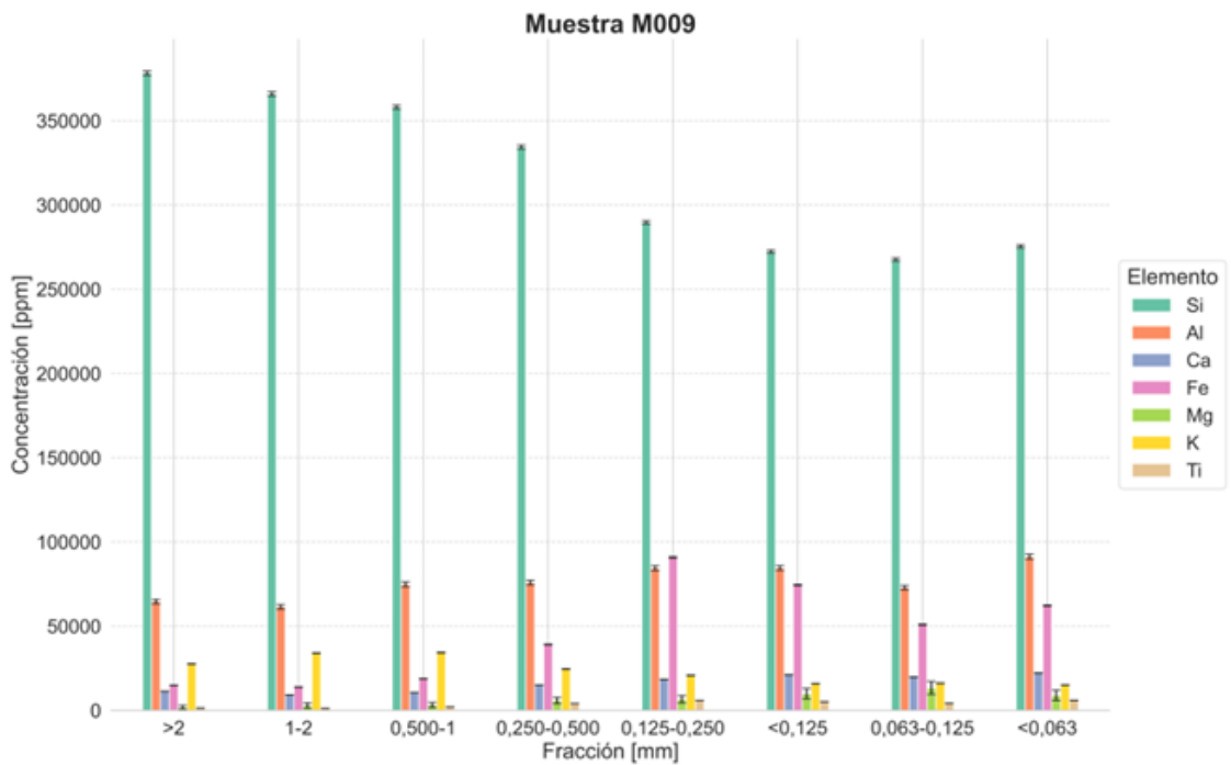
Figura 7. Distribución geoquímica de elementos mayoritarios por tamaño de grano. El Si y K, se maximizan en las fracciones entre 1 – 2 mm y > 2 mm. El Fe, Al, Ti, Ca y Mg se posicionan en las fracciones entre 0.125 – 0.250 mm, < 0.125 mm y < 0.063 mm.
